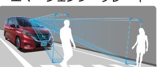
フロントカメラで前方の車両や歩行者を検知。衝突の可能性が高まるときメーター内のディスプレイへの警告表示とブザーでドライバーに回避操作を促します。万一、ドライバーが安全に減速できなかった場合には、ブレーキを作動させて衝突を回避、または衝突時の被害を軽減します。約10~80km/hの範囲で作動します。歩行者に対しては、約60km/h以上では作動しません。
