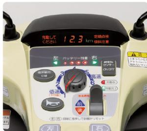
走行距離、定期点検、傾斜注意、充電案内、バッテリー残量等を表示します。
