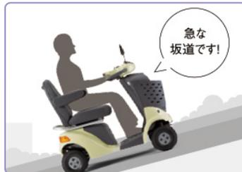
傾斜センサーが登り坂や下り坂だけでなく、左右の傾きも感知。次のような角度でディスプレイの傾斜表示灯が点灯します。
