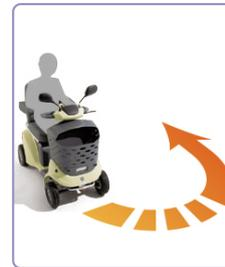
時速4.5kmを超える速度で走行している場合、ハンドルを切った角度に応じて自動的に時速4.5kmまで減速します。
