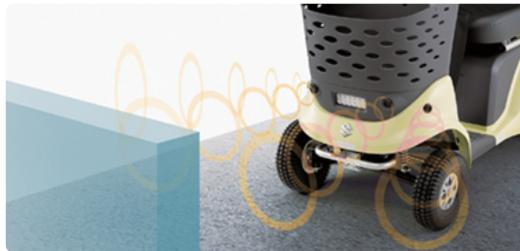
障害物検知サポートは、正対する壁や太いポールなどの前方の障害物を障害物センサーが検知すると、運転者に警告し、車両を減速させることで、安全運転をサポートする機能です。
